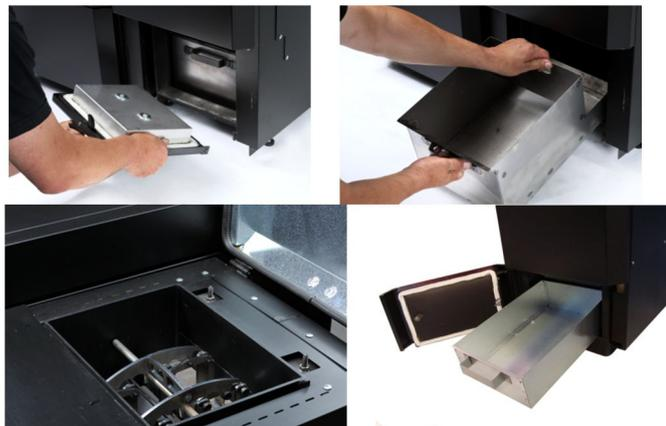
**Automatische Wärmetauscher Reinigung**
