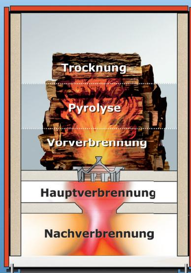
La combustione della legna consiste essenzialmente in 3 fasi: l'essiccazione, la gasificazione (pirolisi) e la combustione reale.
