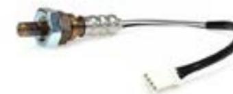
Sonda lambda (controllo ossigeno)
